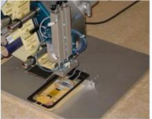
Das Warengut kann in allen Lagen an die Etikettier Position gelegt werden, je nach gewünschter Ausrichtung der Etikette.
