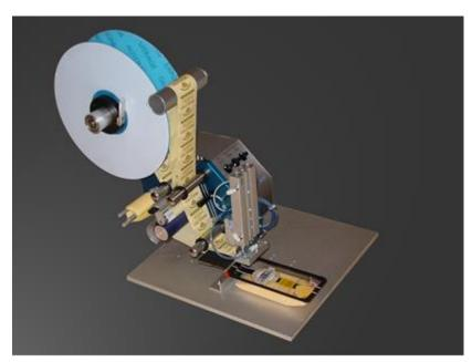
Halbautomatisches Etikettiersystem mit Etikettiergerät und Pneumatik Applikator auf einer Tischplatte
