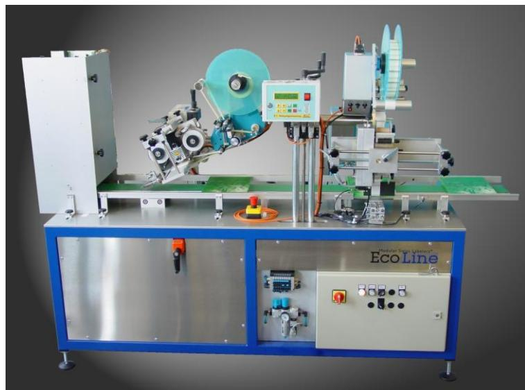
Nach der Kennzeichnung werden die Produkte in einem Aufstapler aufgenommen
