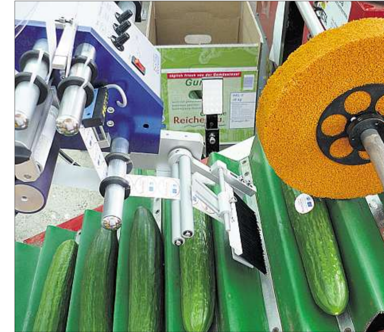
Nachdem ein Mitarbeiter das grüne Förderband mit Gurken gefüllt hat, erledigt die Maschine den Rest. Sie beklebt bis zu 30 Gurken pro Minute. (zvg)
